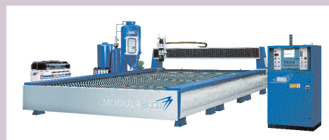
Waterjet machine compleet met tafel, brug, pomp, besturing en intensifier.
