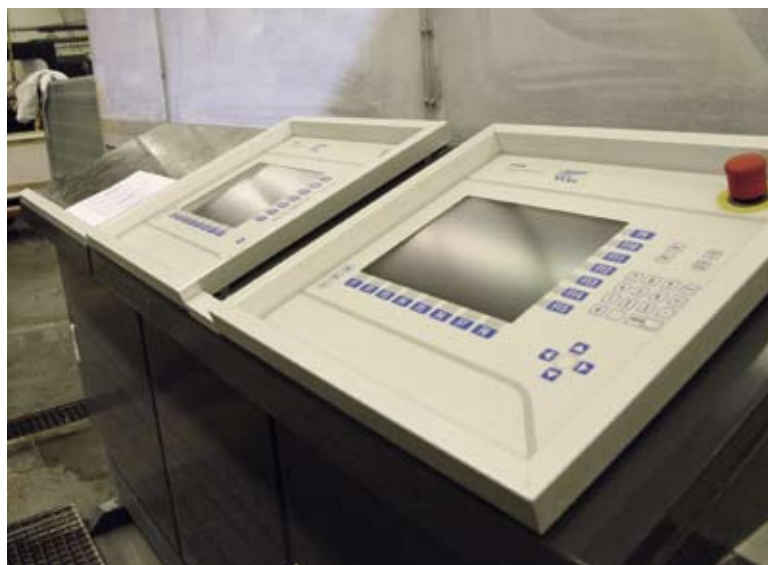
De frees-kalibreermachine heeft niet één, maar twee bedieningspanelen.
