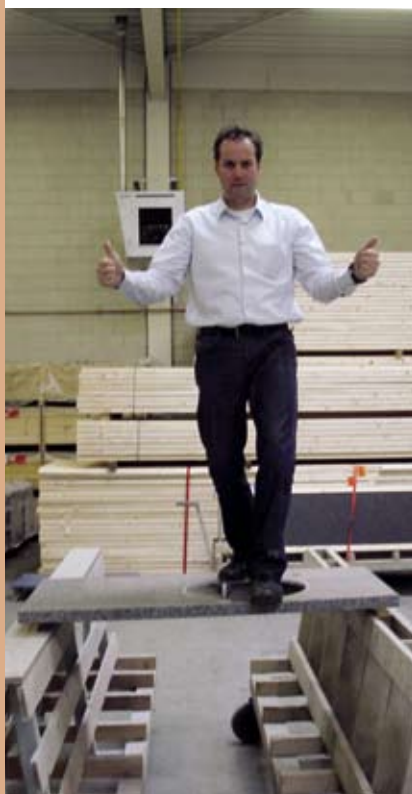
Het keukenblad geeft geen kick, dankzij een nieuw systeem van onderlijming.
