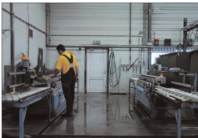
Twee van de vijf lopende band kantenpolijstmachines MARMO MECCANICA die Lion Stone rijk is
