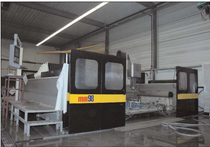
Het nieuwe cnc bewerkingscentrum van OMAG met dubbele tafel in alternerende werking speciaal voor het kalibreren, frezen en polijsten van de keukenbladen
