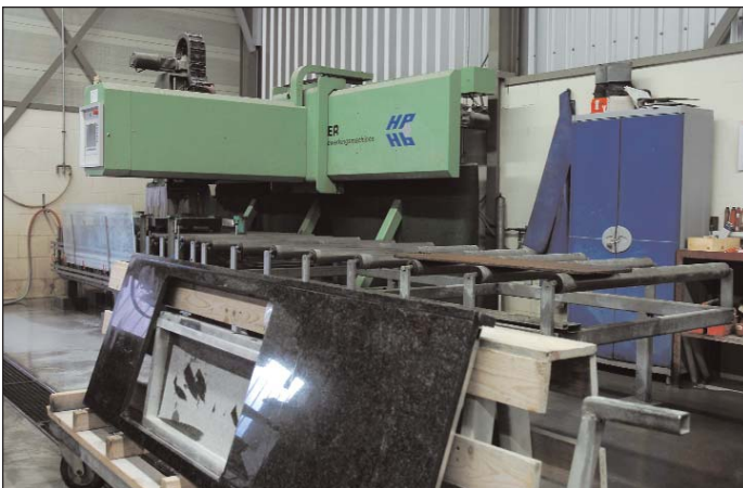
Eén van beide volautomatische freesmachines van PATER met gereedschapswisselaar
